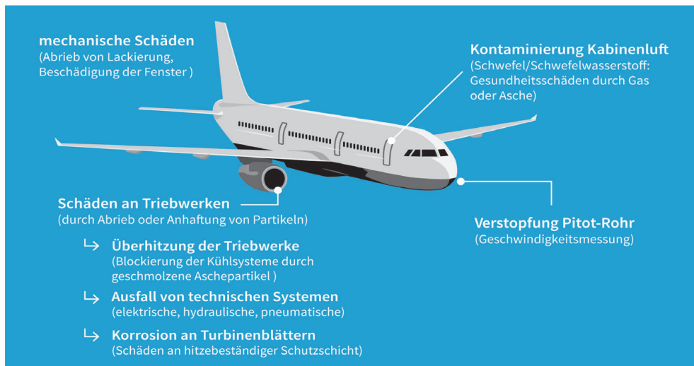
Abb. 3: Vulkanasche und Flugverkehr: Überblick über ausgewählte Schäden am Flugzeug durch Vulkanasche.
